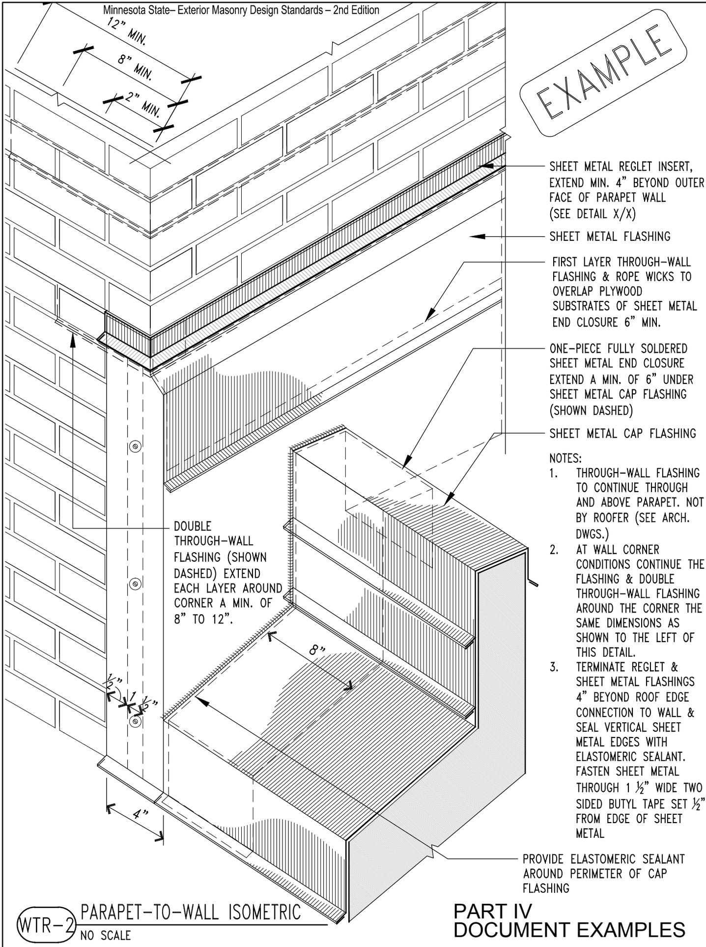
SHEET METAL REGLET INSERT, EXTEND MIN. 4" BEYOND OUTER FACE OF PARAPET WALL (SEE DETAIL X/X)
