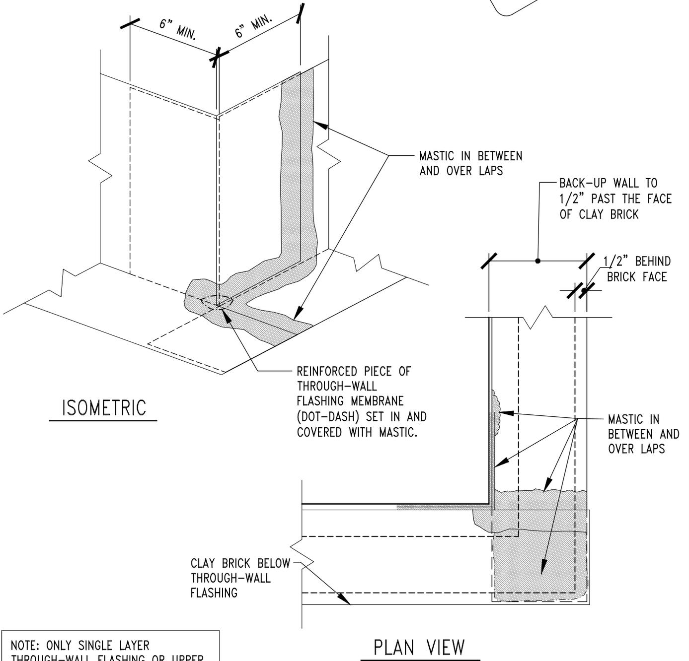
NOTE: ONLY SINGLE LAYER THROUGH-WALL FLASHING OR UPPER LEVEL OF DOUBLE THROUGH-WALL IS SHOWN. FOR LOWER LAYER OF DOUBLE THROUGH-WALL FLASHING, MEMBRANE IS EXTENDED TO TIE-IN TO ROOF BASE FLASHING.
